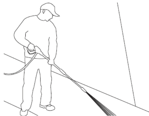
Рис. 7 – Оптимальный угол падения струи на очищаемую поверхность
